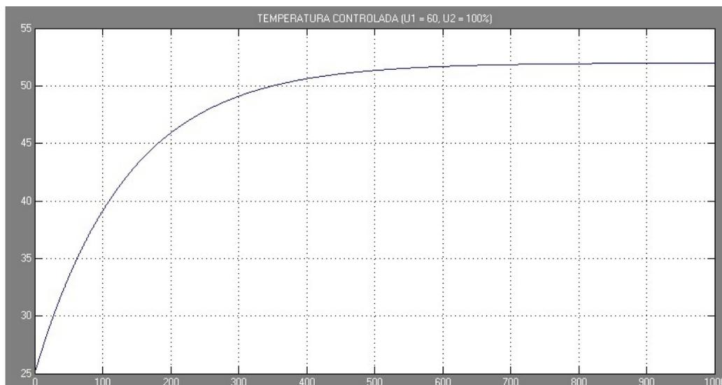
Figura 24: Controle Térmico para a Situação 01 ( $U_1 = 60^\circ\text{C}$  e  $U_2 = 100\%$ ).
