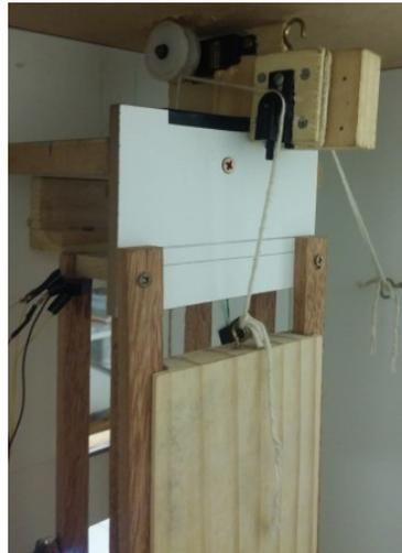
Figura 36: Elevador 1 - Motor de tração e contrapeso.
