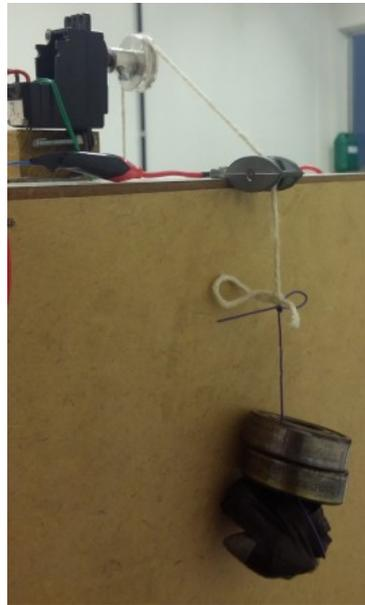
Figura 43: Elevador 2 - Motor de tração e contrapeso.
