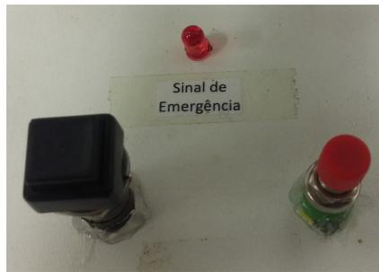
Figura 39: Elevador 2 - Botoeira de emergência e chave geral.
