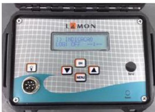
Figura 15: Datalogger de Pressão.
