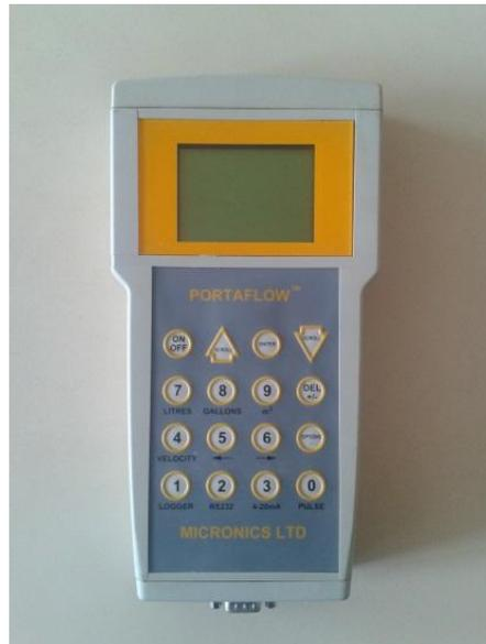
Figura 16: Macromedidor de vazão ultrassônico.
