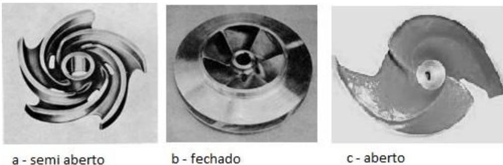
Figura 3: Tipos de rotores.
