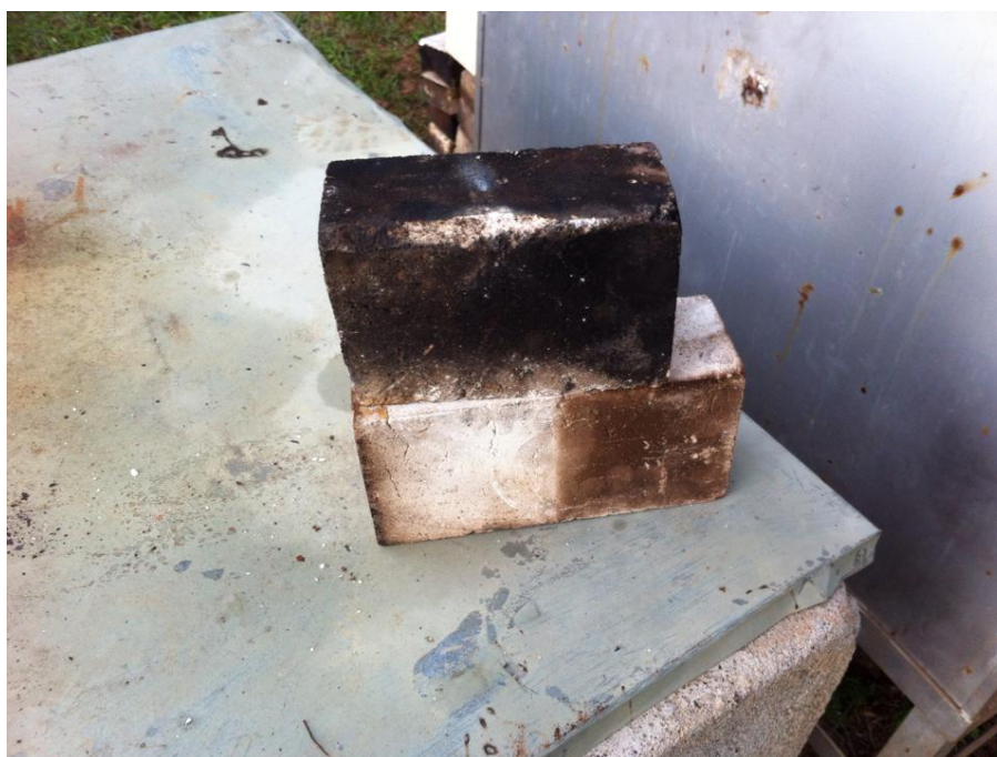
Figura 12 - Tijolos refratários usados na criação do protótipo.
