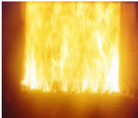
Figura 4 - Cor, Aspecto e Forma Ideais da Chama para Biomassa. Fonte: BRANCO.
