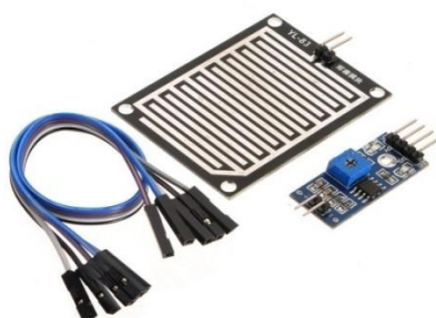
Figura 4 - Conjunto de conexão. Da esquerda para direita: fios conectores, sensor de chuva (YL-83) e módulo de controle.
