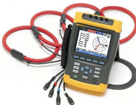
Figura 13 – Analisador de Qualidade de Energia Trifásica Fluke 435.
