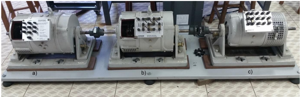
Figura 22 - Conjunto didático de máquinas. a) Máquina CC. b) Máquina síncrona. c) Máquina assíncrona.
