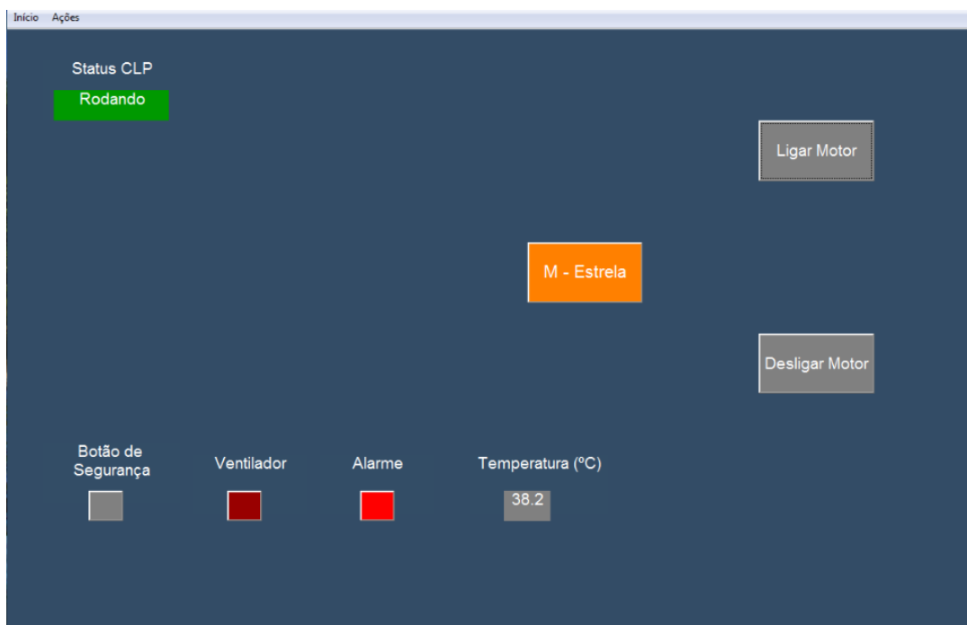
Figura 35: Após pressionado o botão ligar motor, este liga-se em estrela.
