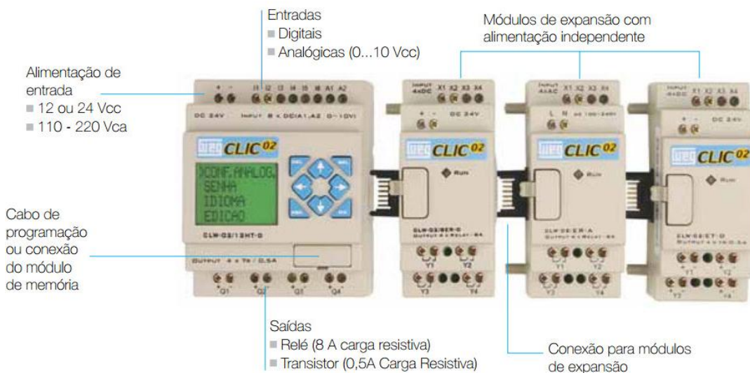
Figura 4: CLP Click-02, estrutura básica
