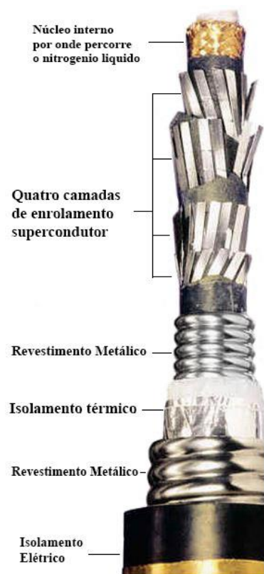
Figura 11 - Perfil estrutural do cabo utilizado no projeto Edison Detroit
