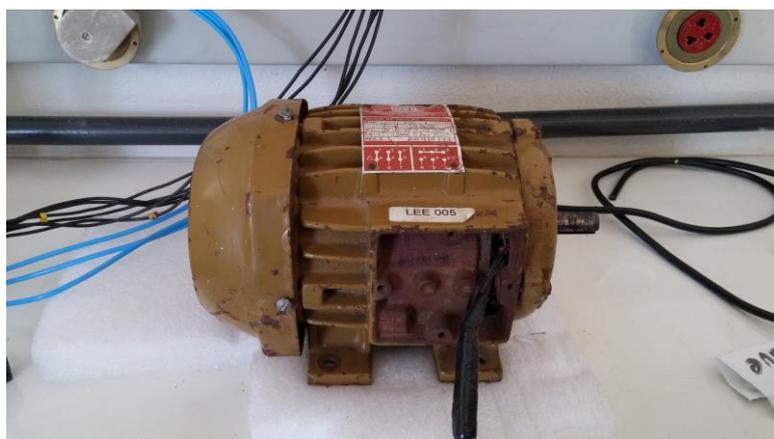
Figura 11 – Motor de indução trifásico
