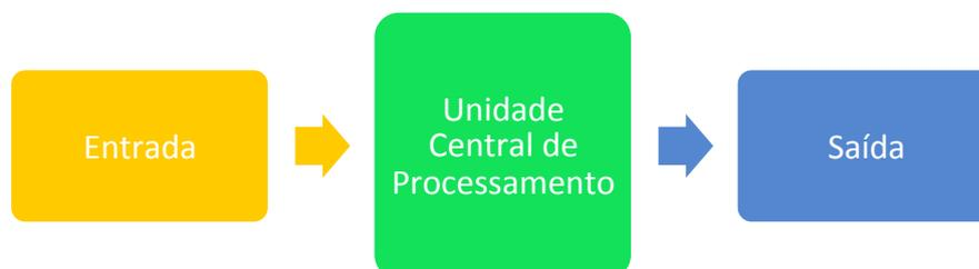
**Figura 4 - Estrutura básica de um PLC.**
