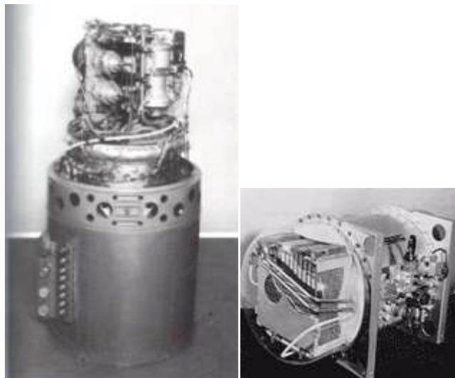
**Figura 3 - Pilhas a combustível hydorx utilizadas nas missões Apollo e Gemini respectivamente.**
