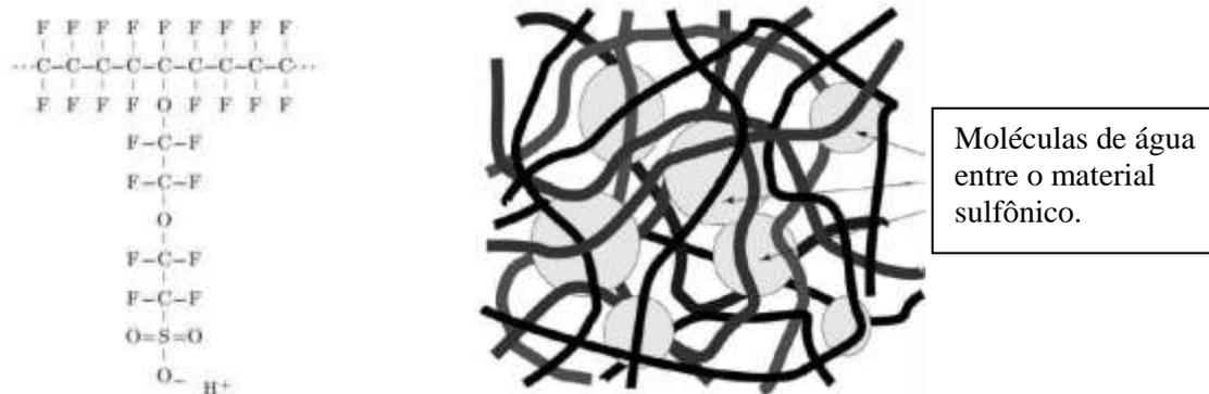
Figura 6 - Formula química e estrutura da membrana do tipo Nafion<sup>®</sup>. [18]
