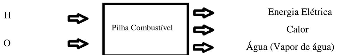
Figura 8 - Fluxograma simplificado de funcionamento de uma célula combustível.
