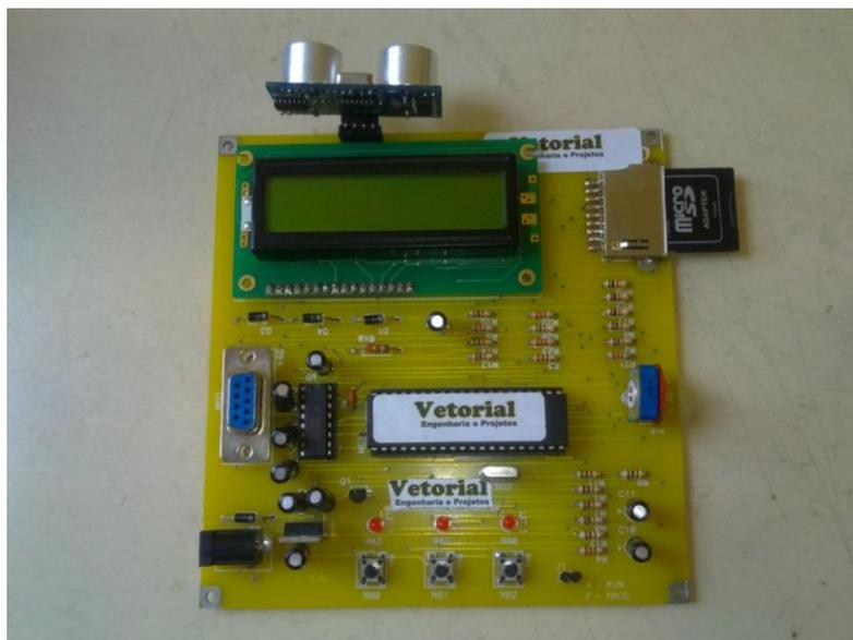
Figura 23 – módulo de testes para o sensor de nível e comunicação com cartão de memória
