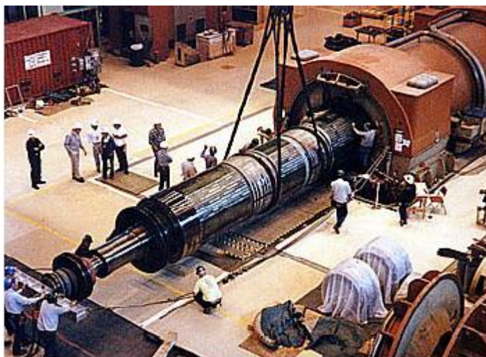
Figura 2-3 Rotor de pólo cilíndrico de um turbo gerador
