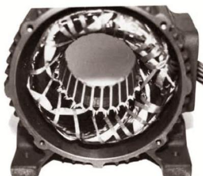
Figura 4 - Estator de uma típica máquina de indução mostrando os enrolamentos
