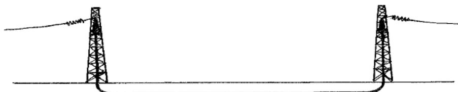
Figura 21 - Conexão em sifão.
