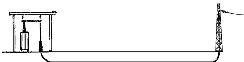
Figura 20 - Conexão aero-subterrânea.
