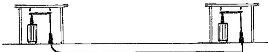
Figura 19 - Conexão subterrânea entre postes.
