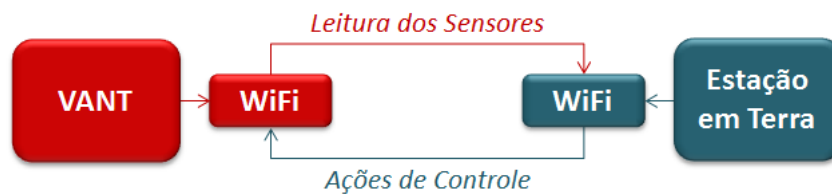
Figura 6: Comunicação entre o VANT e a estação terrestre.
