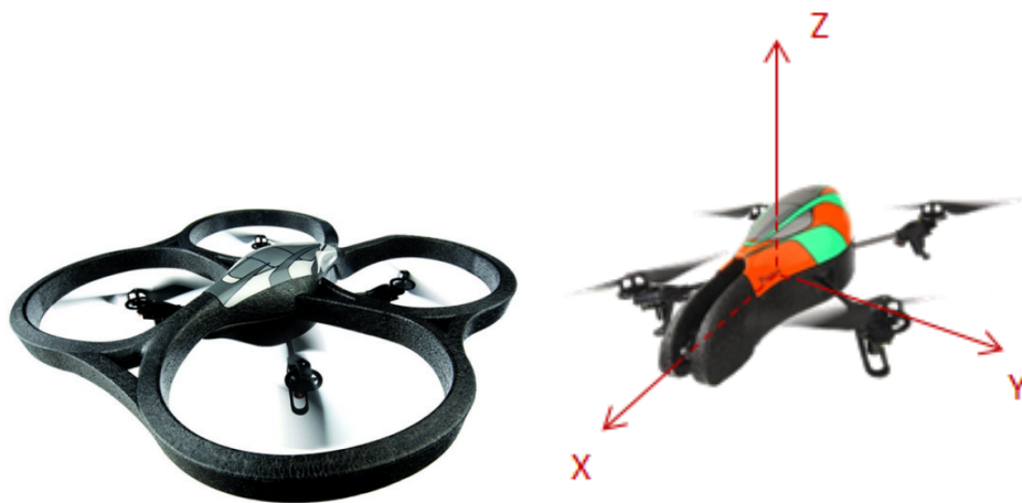
(a) Quadrotor AR-Drone Parrot. (b) Sistema referencial fixo do AR-Drone.
