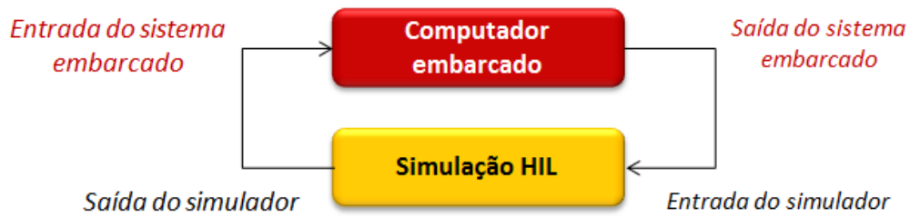
Figura 1: Estrutura do Hardware-in-Loop Simulation .
