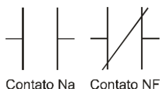
Figura 8: Configuração de contato no diagrama Ladder.
