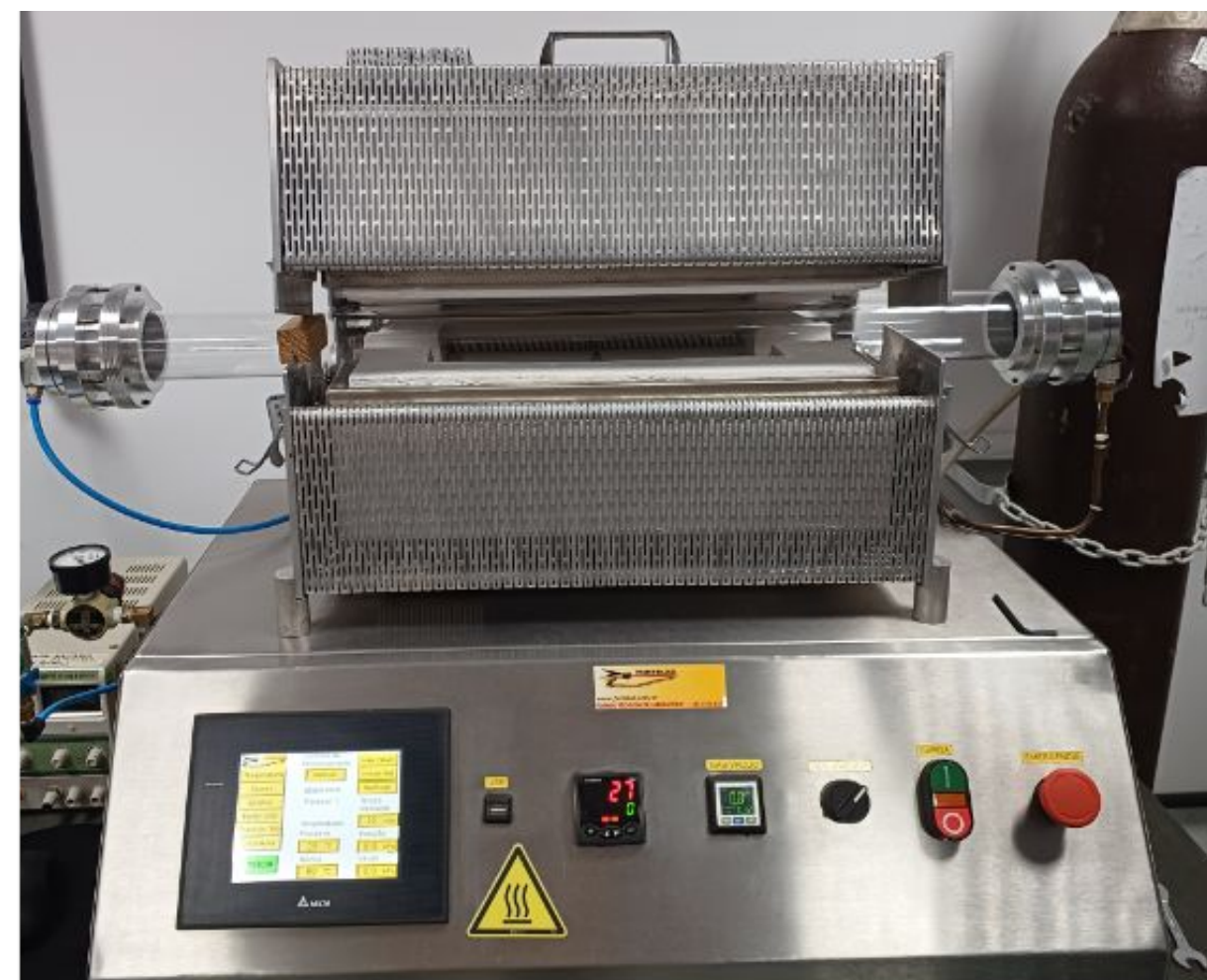
Figura 1: Imagem e representação do sistema de deposição física de vapor.
