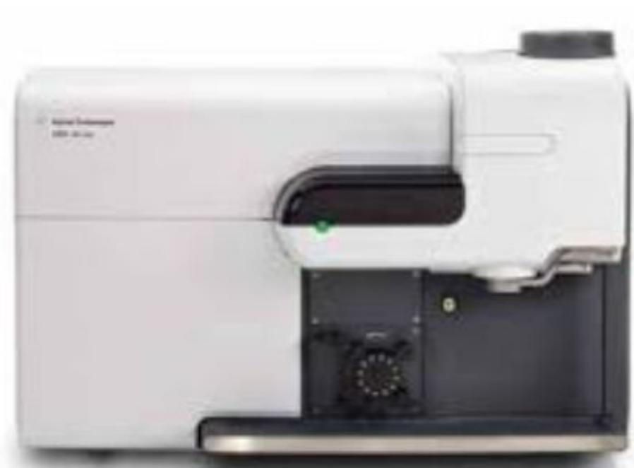
Espectroscopia de emissão óptica com plasma induzido por micro-ondas (MIP-OES)
