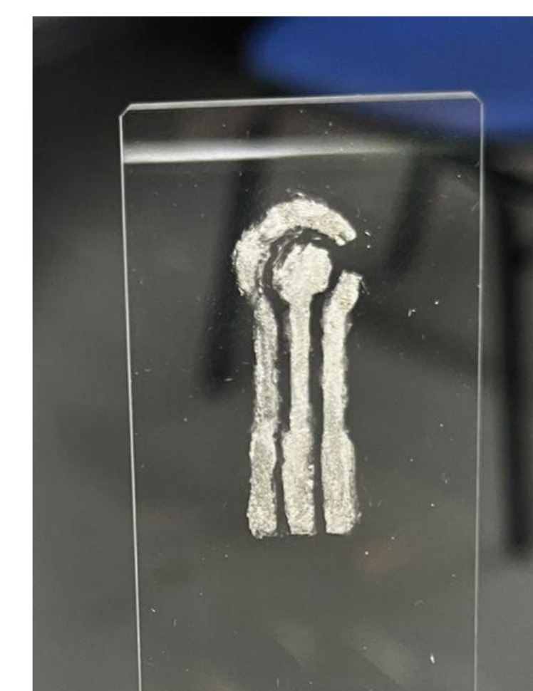
Figura 2- Aplicação da tinta condutiva de prata no sensor.
