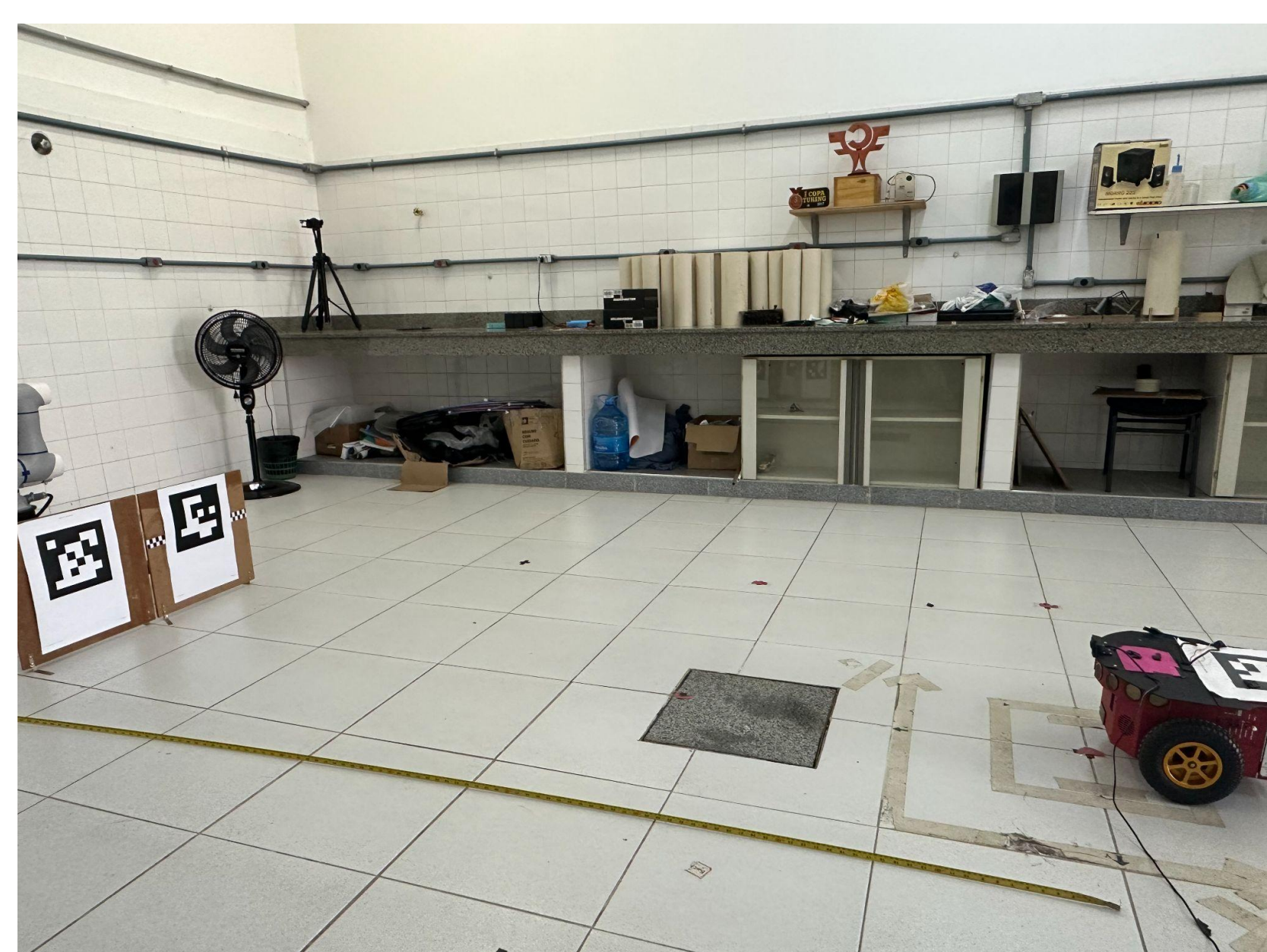
Figura 1 - Experimento realizado com ArUco e AprilTag.
