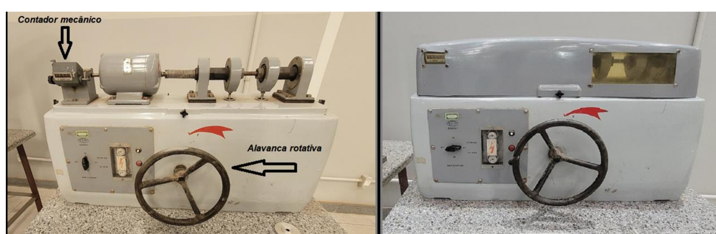
Figura 1 - Máquina de ensaio de fadiga R.R. Moore do LEM/UFV antes das adaptações.
