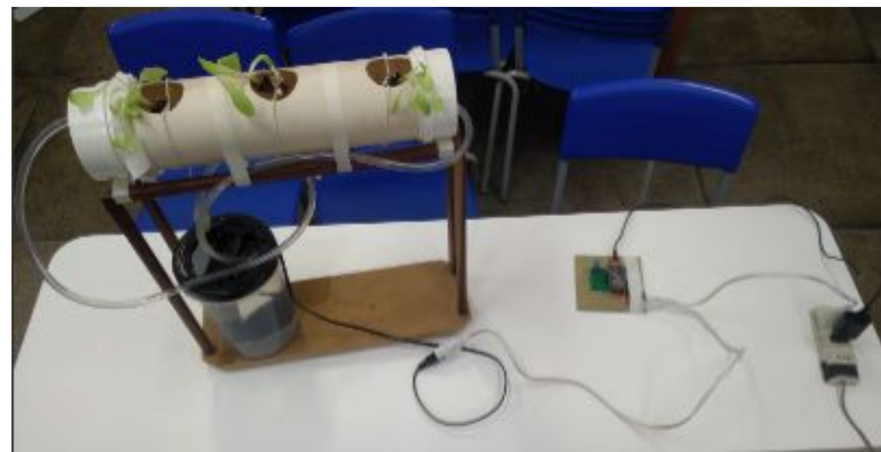
Figura 1: protótipo inicial de um sistema hidropônico automatizado com um NodeMCU, módulo relé e sensor DHT11.
