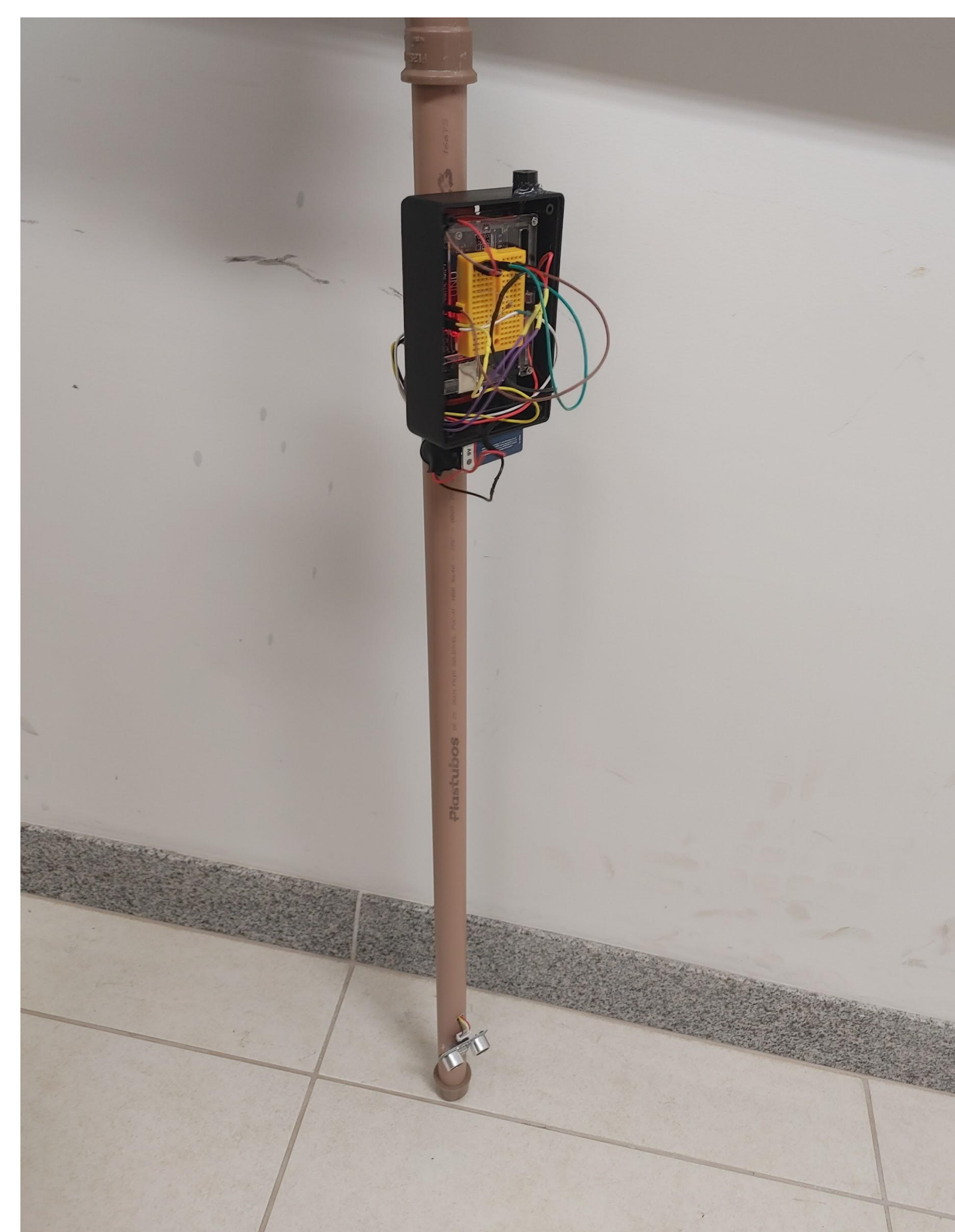
Protótipo de bengala eletrônica feita com materiais hidráulicos de PVC.
