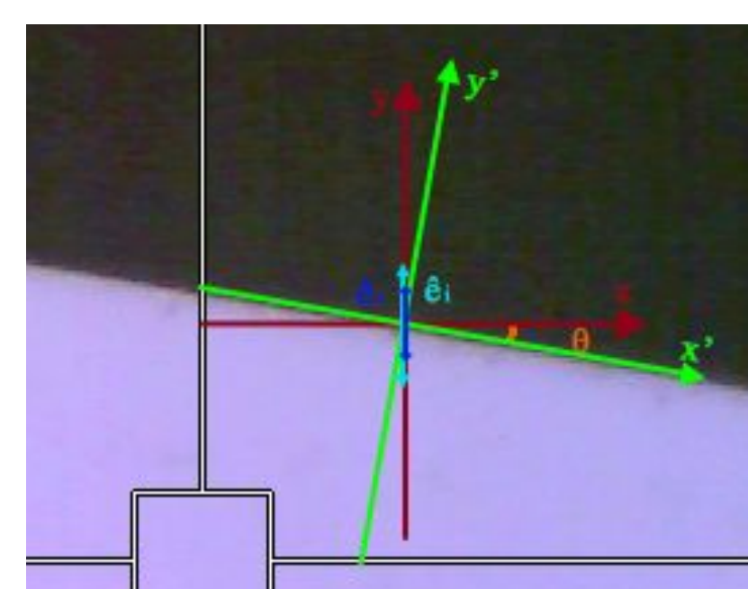
Fig. 5 - Configuração de polarização tomando a direção da clivagem como referência do Si(100)
