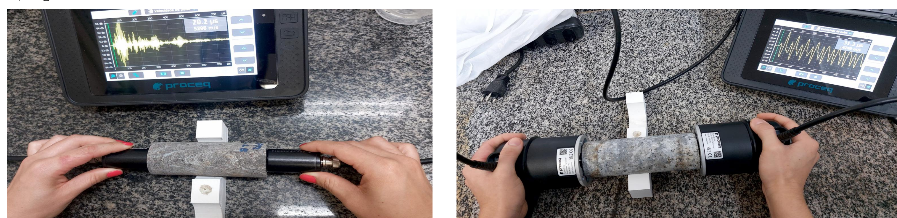
Fig. 1 - Ensaio de velocidade de propagação de ondas elásticas. a) Ondas P; b) Ondas S. c) Apoios
