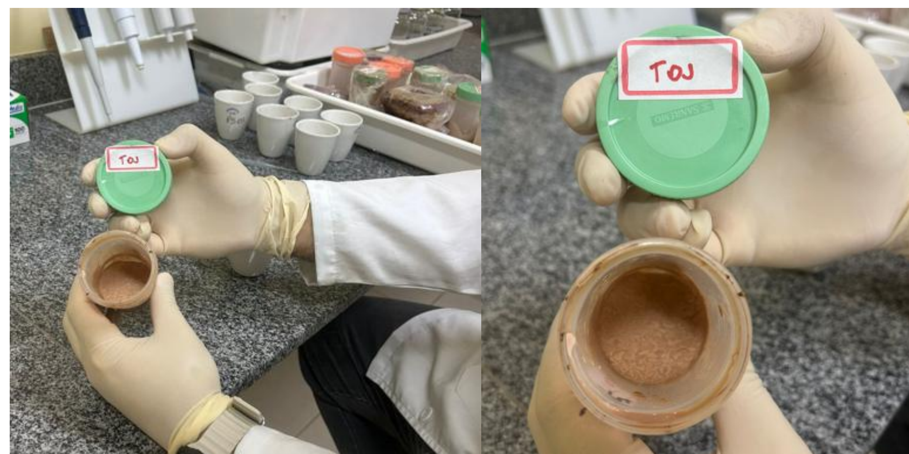
Figura 02: Látex de Hevea brasiliensis com adição de taninos vegetais, totalmente líquidas após 180 dias de armazenamento. Laboratório de Propriedades da Madeira (LPM/UFV).
