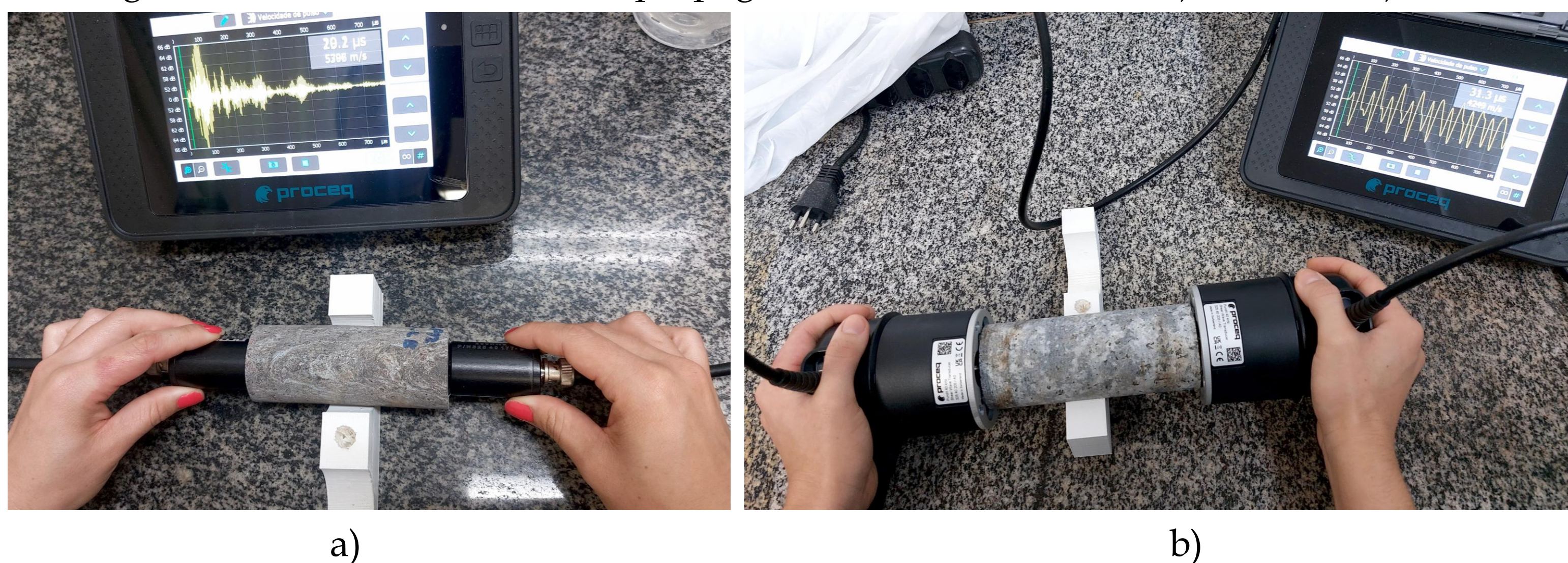
Fig. 1 – Ensaio de velocidade de propagação de ondas elásticas. a) Ondas P; b) Ondas S.
