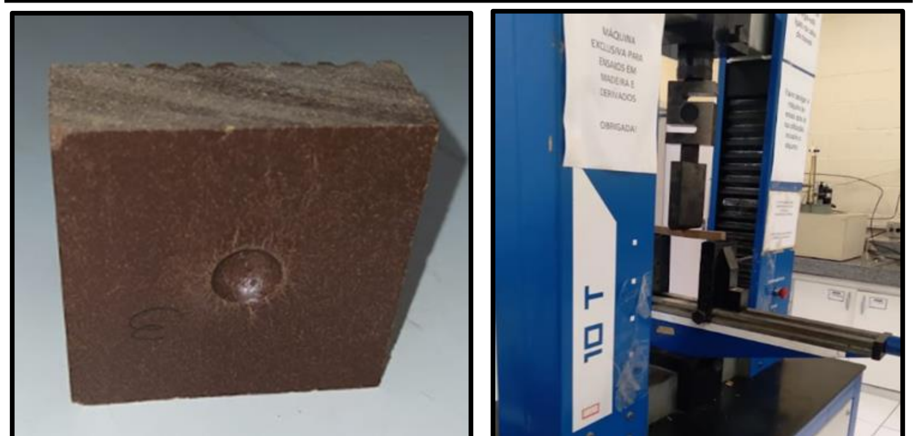
Figura 2. Valores médios dos ensaios de dureza janka, flexão estática e detalhe do corpo de prova para os ensaios mecânicos.
