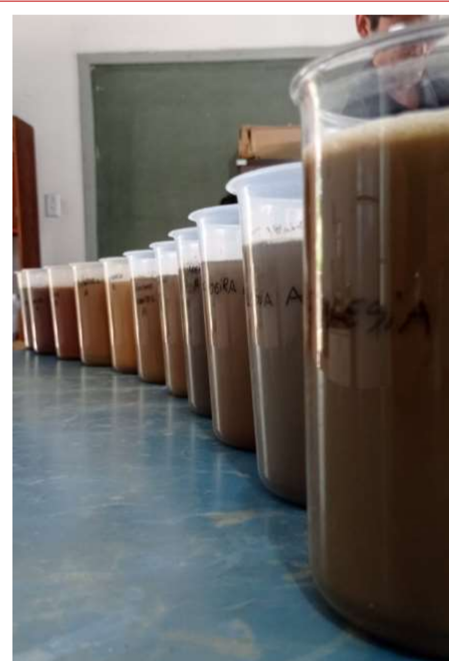
Fig. 2 - Fracionamento da matéria orgânica e isolamento de substâncias húmicas.
