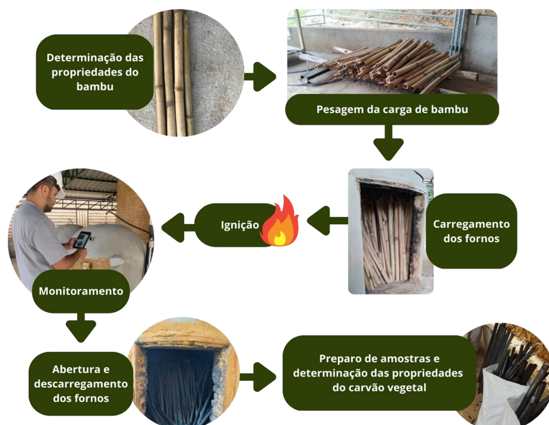
Figura 1. Esquema de carbonização do Bambusa vulgaris
