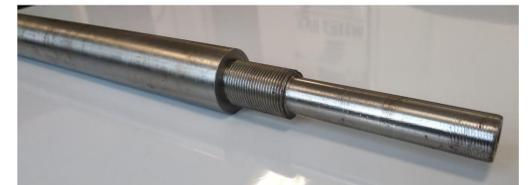
Figura 3: Imagem parcial do corpo de prova feito de barra de aço SAE 1045
