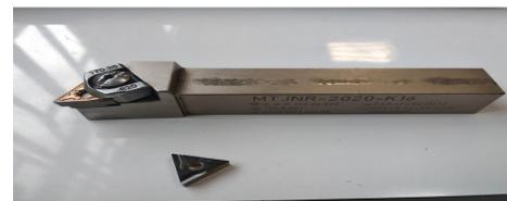
Figura 2: Conjunto suporte mais a ferramenta de corte, a qual é feita de metal duro endurecido superficialmente
