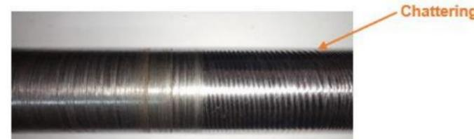
Figura 4. Corpo de prova torneado, nota-se à esquerda a superfície lisa e à direita, indicada pela flecha, a presença do chattering - com a piora da qualidade superficial.
