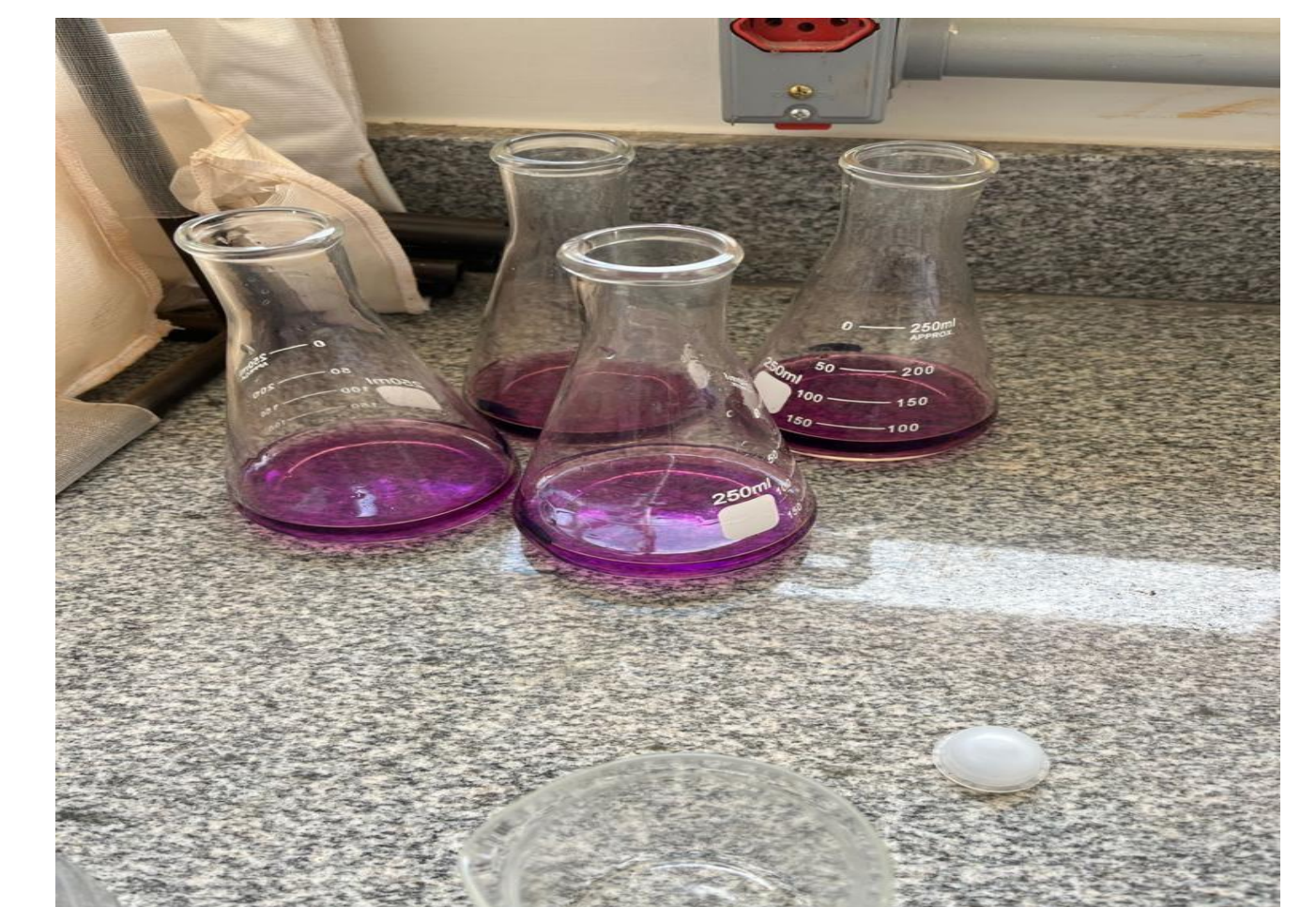
Figura 4: método de Kjeldahl para a quantificação do resíduo de nitrogênio (N)NH_4 .
