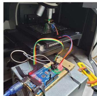
Figura 4 - Base giratória sendo usada para medidas de espectroscopia Raman polarizado.
