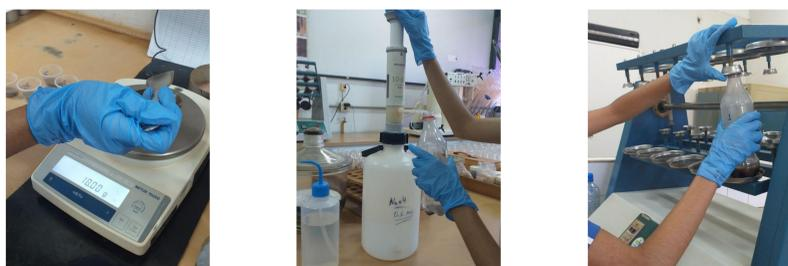
Figura 1 - Alguns dos passos da metodologia da análise granulométrica de solos em laboratório.
