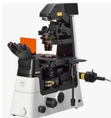
Figura 1 - Modelo de Microscópio Óptico Nikon Eclipse Ti2-U. Usado na montagem da pinça holográfica
