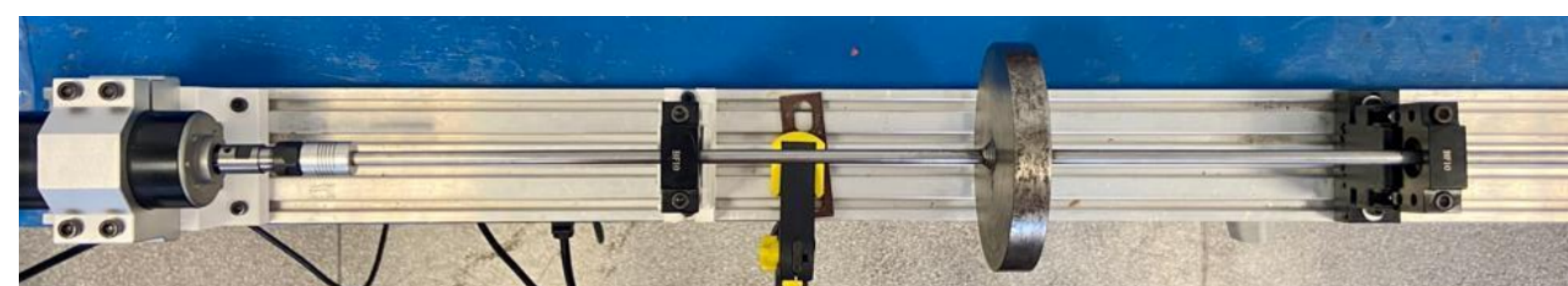
Figura 3. Bancada de rotodinâmica, usada para ensaios de vibrações torcionais - o acelerômetro é montado no disco de inércia.
