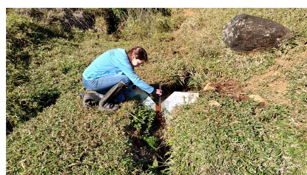
Imagem 2 - Medição da vazão pelo vertedor triangular
