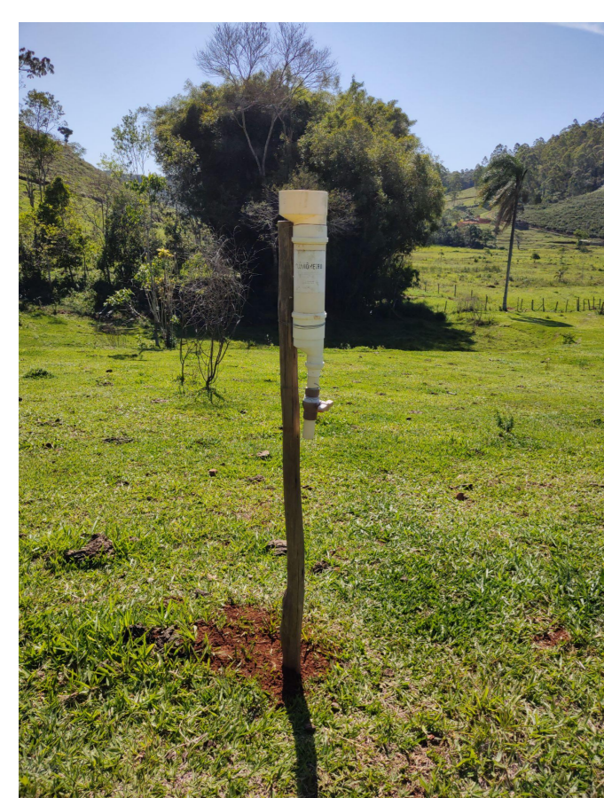
Imagem 1 - Pluviômetro de diâmetro 150 mm para o monitoramento das chuvas em cada nascente
