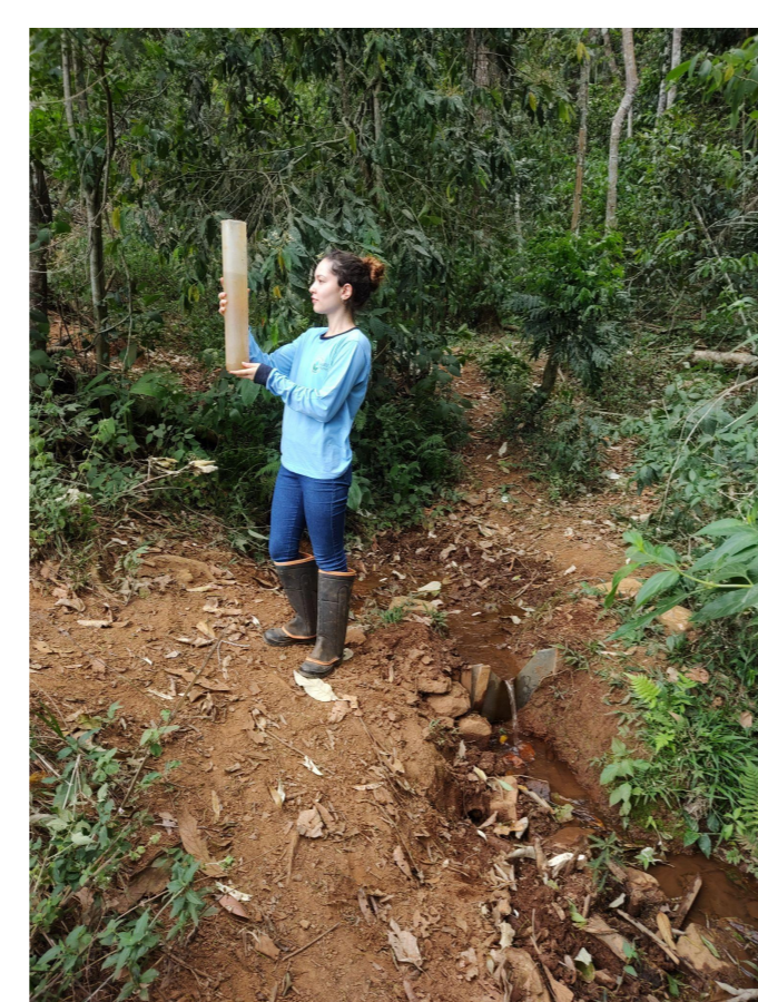
Imagem 3 - Medição da vazão pelo método direto
