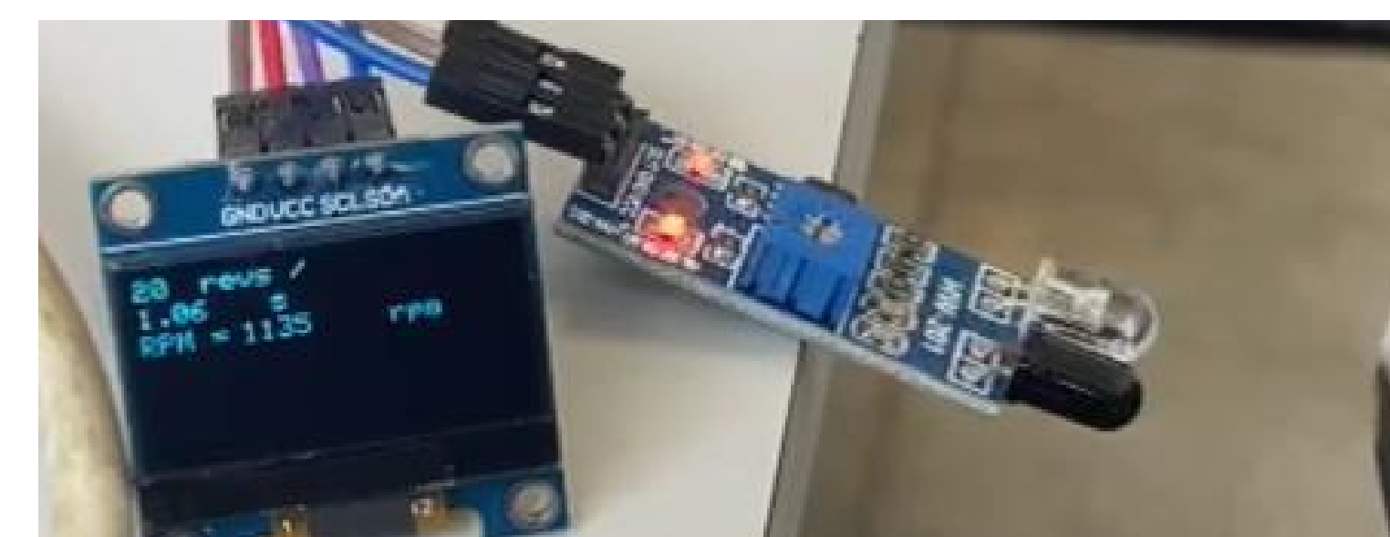
Sensor que mede as RPM, com resultado no DISPLAY
