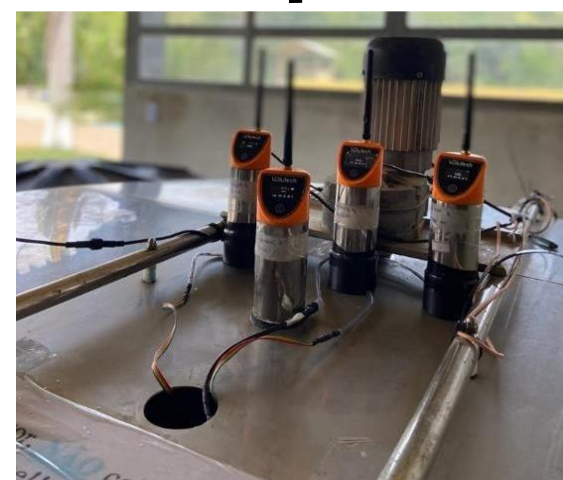
Imagem 5. Sensores acoplados na tampa no tanque para medir o volume.
