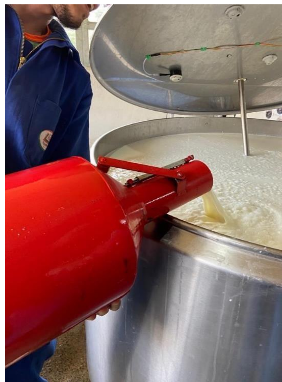
Imagem 2. Transferência do volume conhecido para o tanque de expansão.
