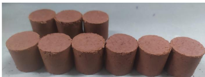
Figura 1 - Corpos de provas ensaiados a resistência à compressão.
