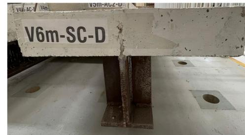
Figura 1 - Seção transversal de uma *Crestbeam*.
