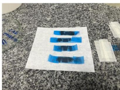
Fig 1: 4 Substratos em contato com fita azul esfoliada
