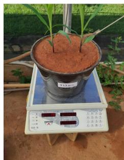
**Figura 2.** Manutenção da umidade a 50 e 80% da capacidade de campo e determinação de matéria seca via gravimetria.
