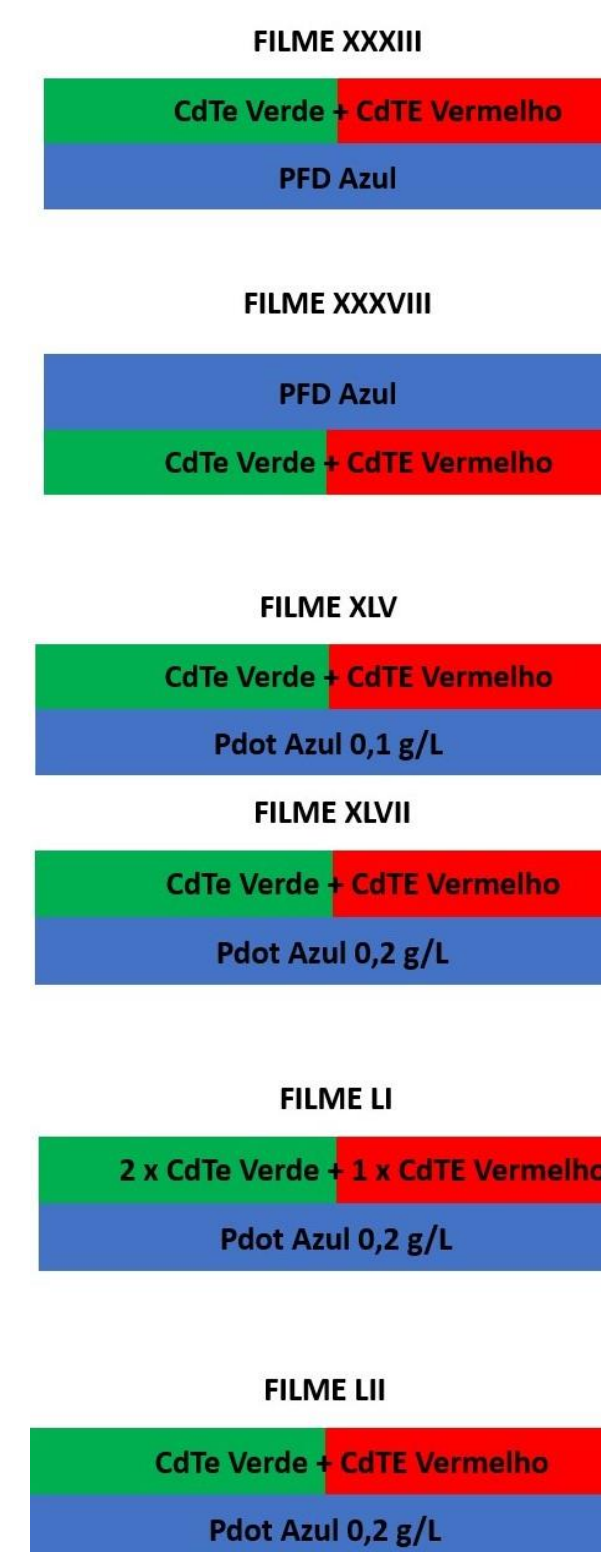
Figura 2- Esquema de como os filmes finos foram obtidos. As camadas foram produzidas por spin-coating ou drop casting .
