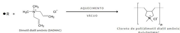
A necessidade de cada etapa segue sendo analisada, como o uso do gás inerte (Nitrogênio) e adição de EDTA. O produto obtido está sendo caracterizado por diferentes técnicas como FTIR, viscosidade, teor de polímeros ativos, entre outras. Além de análises comparativas, estudos cinéticos e testes de aplicação.
