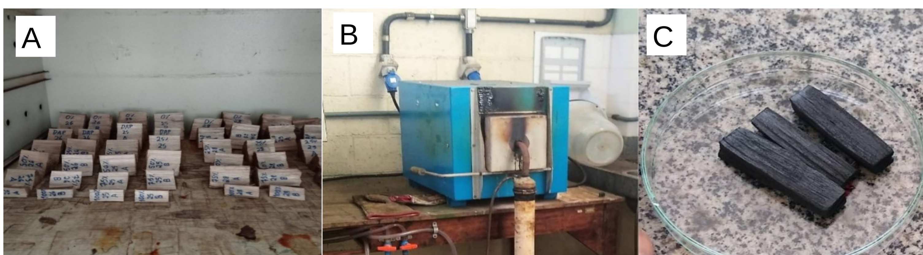
Figura 1. a) Madeiras de E. globulus para carbonização b) Forno elétrico tipo mufla para carbonização da madeira c) Carvão de E. globulus .
