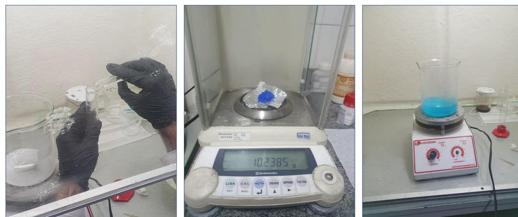
**Figura 3:** Processo de fabricação do supercondutor como a adição de ácido nítrico na solução (1), pesagem dos materiais (2) e aquecimento e agitação da solução final formada a fim de se obter o produto final desejado (3).
