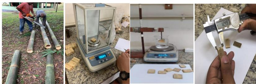
Detalhes do seccionamento do bambu e medições de densidade e estabilidade dimensional.
